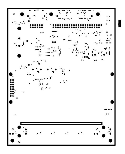
PWB 513401 REV B 2-23-10 GND PLANE - LAYER 2
